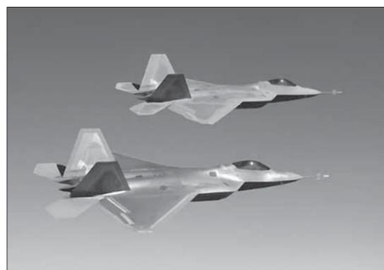
F-22 (на фото) является первым серийным самолетом пятого поколения. Взлетный вес машины превышает 27 тонн, радиус действия — 1100 километров, максимальная скорость равна 1900 километрам в час, что примерно в полтора раза превышает скорость звука. Боевая нагрузка размещается в подфюзеляжных отсеках, что понижает заметность машины в радиолокационном диапазоне (технология «стелс»). Следует отметить, что F-22 является самым дорогим в мире истребителем — его цена превышает 300 миллионов долларов.
